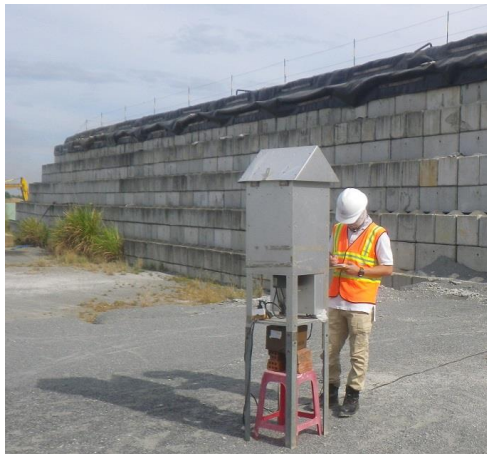
Lấy mẫu không khí ở xung quanh kết cấu xử lý trong quá trình làm nguội. (Ảnh: CDM Smith)
