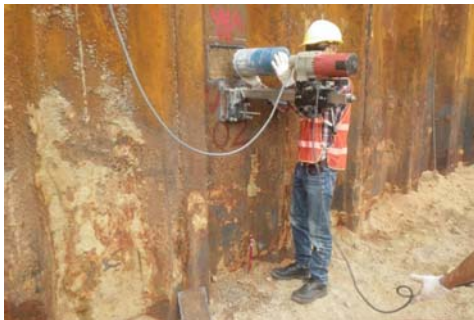
Thu thập mẫu khoan lõi bê tông của thành mỏ để phân tích khả năng cách nhiệt sau khi xử lý giai đoạn 1 (Ảnh: CDM Smith)
